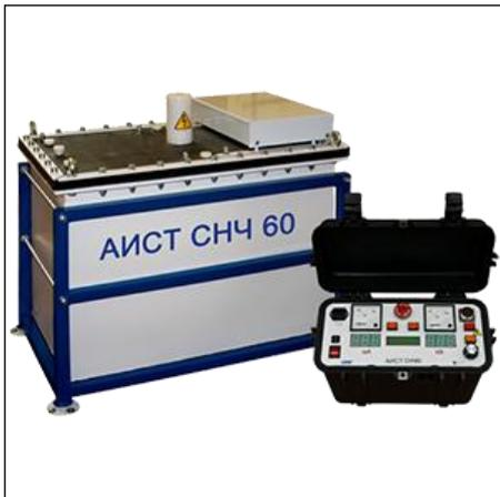
Высоковольтная установка для испытания кабелей из сшитого полиэтилена (СПЭ) АИСТ СНЧ 60 предназначена для:
