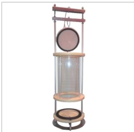
Планктоботометр предназначен для отбора водных и зоопланктонных проб.
