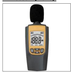
Недорогой компактный интегрирующий **измеритель уровня зву-** ка (шумомер) **АКТАКОМ АТТ-9080** имеет встроенный конденсаторный микрофон, он обеспечивает диапазон измерения звука в пределах от 30 до 120 дБ в полосе частот от 31,5 Гц до 8 кГц.
