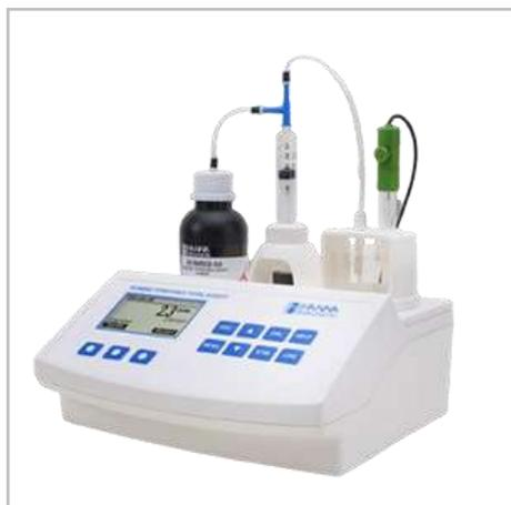
Минититраторы НИ 84500; НИ 84502; НИ 84529; НИ 84530; НИ 84531; НИ 84532; НИ 84533 позволяют автоматически проводить такие важные и времяемкие анализы как определение кислотности, щелочности, формольного числа, диоксида серы быстро и с высокой точностью.
