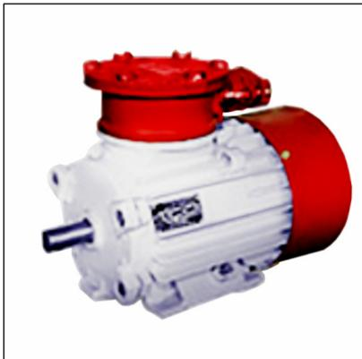
Электродвигатель взрывозащищенный трехфазный асинхронный с короткозамкнутым ротором **ВА05П280** предназначен для привода стационарных машин и механизмов (насосов, вентиляторов и др.) в шахтах, опасных по содержанию рудничного газа (метана) и угольной пыли, а также во взрывоопасных производствах внутренних и наружных установок нефтеперерабатывающей, газовой, химической и других отраслей промышленности. Двигатель разработан взамен двигателей ВА02-280 и 2В(Р)280.
