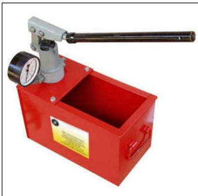
Установка «УГИ» предназначена для опрессовки резервуаров, колов, различных емкостей и систем трубопроводов. Установка может быть использована для работ различных гидравлических устройств (домкратов, центраторов, струбцин), не имеющих собственного привода.
