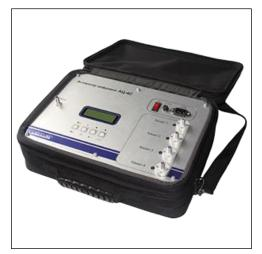
Аспиратор АЦ-4С предназначен для отбора проб воздуха и (или) газа с заданным объемом при выполнении газоаналитических измерений. Аспиратор позволяет отбирать пробу заданного объема прямым измерением, с установкой расхода со стабилизацией при контроле атмосферного воздуха и воздуха рабочей зоны.
