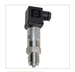
Датчики избыточного давления DMP-330M, DMP-330MS предназначены для пропорционального преобразования давления рабочей среды (неагрессивные к нержавеющей стали жидкости и газы) в электрический сигнал 4...20 мА с погрешностью 1% от диапазона измерения.
