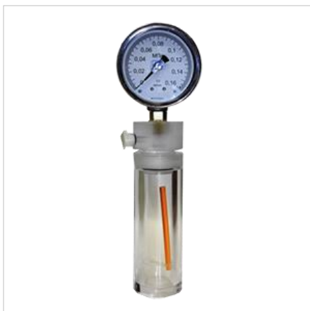
КМ-НТ карбонатомер манометрический (кальциметр) с манометром МТИ-0,16-0,6
