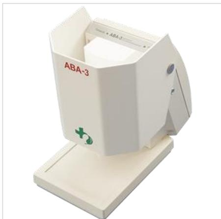
Анализатор АВА-3 предназначен для определения содержания тяжелых токсичных элементов (Cd, Pb, Cu, Zn, Hg, As, Se, Co, Ni, Fe, Cr, Ag, Tl, Te, Mn, йод, фенолы) в различных объектах: вода питьевая, природная, очищенная сточная, воздух, почва, пищевые продукты и др., прошедший метрологическую поверку.
