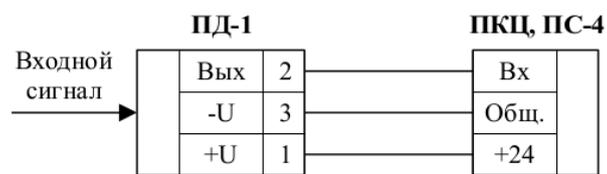
**Схемы внешних соединений ПД-1.х.42, ПД-1М.х.42 с выходным током (4... 20) мА**
