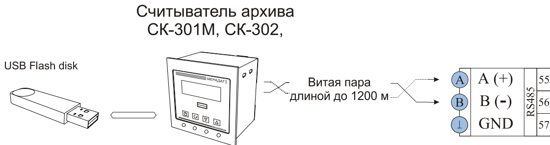
Рис 5.4 Типовая схема подключения прибора к считывателям архива.
