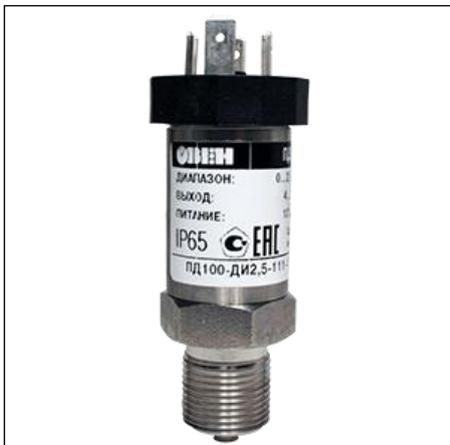
Датчики ПД100-ДИ моделей 111, 171, 181 представляют собой преобразователи давления с измерительной мембраной из нержавеющей стали AISI 316L, сенсором на основе технологии КНК и кабельным вводом стандарта EN175301-803 (DIN43650 А).
