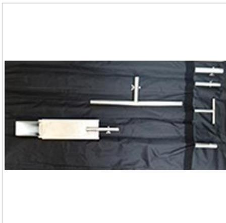
Дночерпатель Робур предназначен для отбора проб донных отложений с частичным разрушением структуры образца.
