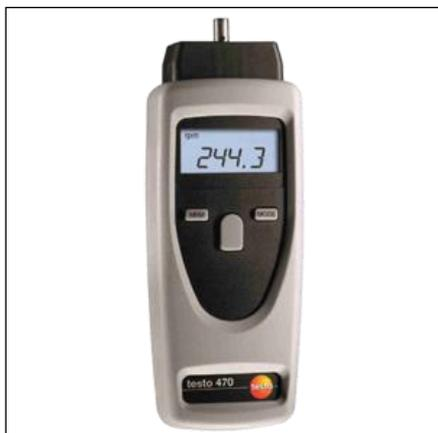
Цифровой тахометр Testo-470 предназначен для измерения скорости вращения. Можно проводить механические измерения, присоединив адаптер наконечника зонда или вращающийся диск для контактного измерения скорости вращения.
