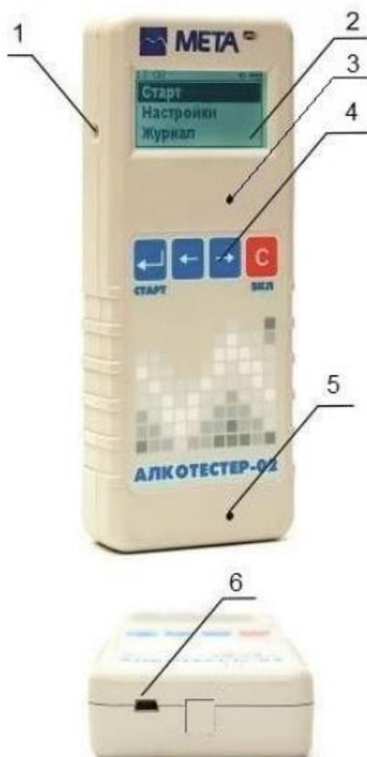
1—Гнездо для установки мундштука (воронки); 2—Дисплей; 3— Индикатор алкоголя; 4 – Кнопки управления, 5 - Индикатор зарядки аккумулятора; 6—Разъем для подключения зарядного устройства.
