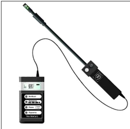
Предназначен для измерения, как фотометрических параметров, так и основных параметров микроклимата: освещённости в видимой области спектра (380 ÷ 760) нм, энергетической освещённости в области спектра (280 ÷ 400) нм — УФ-(А+В), скорости движения, температуры и относительной влажности воздуха внутри помещений.
