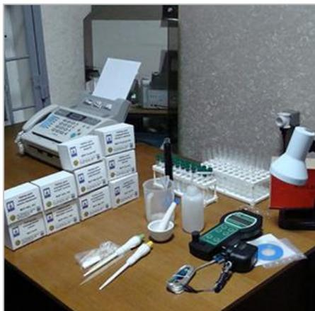
Мини-лаборатория Экотест-АГРО состоит из двух портативных измерительных приборов: фотоколориметра «Экотест-2020-8-РС» и потенциометрического анализатора «Экотест-120/АТС», а также вспомогательного оборудования, реактивов и химической посуды.
