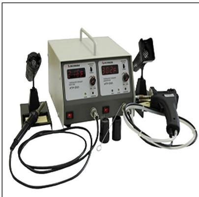
Двухканальная ремонтная паяльная станция **АТР-3101** с цифровой индикацией температуры инструмента питается от сети 220 В. В комплекте поставляется монтажный паяльник 60 Вт/24 В с наконечником АТР-8205 и демонтажный вакуумный паяльник 24 В/60 Вт с наконечником АТР-8812
