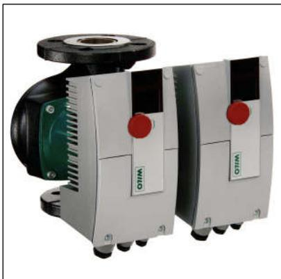
Сдвоенный циркуляционный насос «D-50/1-8» применяется в системах кондиционирования, отопления, закрытых контурах охлаждения, а также в промышленных циркуляционных системах. Насос имеет мокрый ротор, фланцевое соединение, электронно-коммутируемый мотор с автоматической регулировкой мощности.
