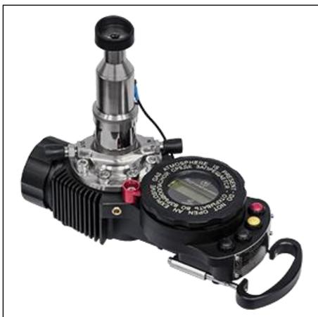
Измеритель точки росы и температуры конденсации углеводородов «Hygrovision-mini» это компактный, переносной, конденсационный гигрометр с электронным охлаждением конденсационного зеркала, предназначенный для измерения в ручном режиме точки росы и температуры конденсации углеводородов.
