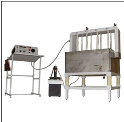
Данный стенд предназначен для испытания изоляции защитных средств, используемых в электроустановках, переменным высоким напряжением. Испытания производятся переменным напряжением частотой 50 Гц и действующим значением, регулируемым до 53 кВ и контролем потребляемой нагрузки тока.
