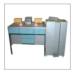
МИП-1110/2,5 (ТУ 4271-001-16632558-99) предназначена для испытания и высокоточного измерения силовых характеристик пружин сжатия под нагрузкой при их производстве, а также в процессе и ремонта различных приборов и устройств, имеющих в своем составе пружины сжатия
