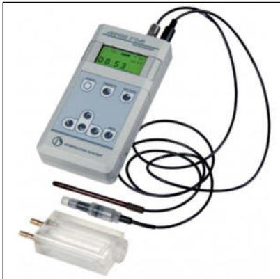
Портативный кислородомер «АНИОН-7041» предназначен для аналитического контроля малых концентраций (от 0,001 мг/дм<sup>3</sup>) растворенного кислорода.
