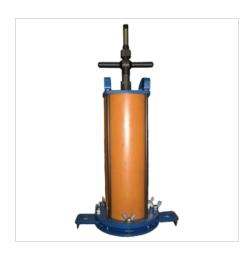
Плотномер ПБД-КМ предназначен для определения плотности грунтов методом замещения объема по ГОСТ 28514-90 в полевых условиях.
