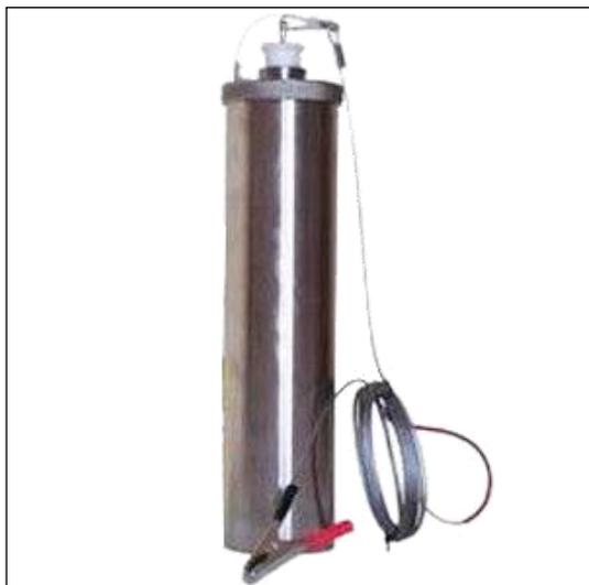
Пробоотборник ПЭ-1640 предназначен для отбора проб нефтепродуктов для определения давления насыщенных паров нефтепродуктов по ГОСТ 1756-2000 из автомобильных и железнодорожных цистерн, стационарных резервуаров.
