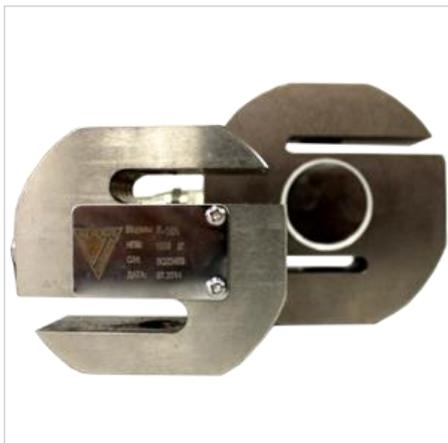
S-образные датчики веса преобразует в электрический сигнал механическую силу сжатия или растяжения. Такие датчики используют в качестве чувствительного элемента в подвесных бункерных, крановых весах. Датчики S-образного типа комплектуются шарнирными подвесами, что сокращает время установки и запуска оборудования в эксплуатацию. Тензодатчики серии К-Р-16А представлены моделями с наибольшим пределом измерений от 20 кг до 10 тонн.
