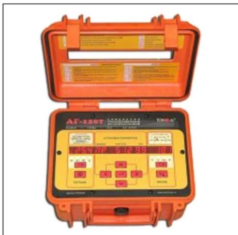
Генератор АГ-120Т предназначен для локализации и диагностики подземных коммуникаций (кабели, трубопроводы) электромагнитным и акустическим методами трассопоиска.
