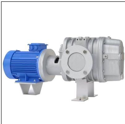
Компрессоры **2АФ** являются сверхнадежными машинами для компримирования, предназначенными для работы с газообразными средами, химически нейтральными по отношению к конструкционной стали, чугуну и минеральным маслам. Газо-, воздуходувки данной серии представляют собой двухроторные агрегаты, рабочие элементы которых выполнены в виде шестерен.
