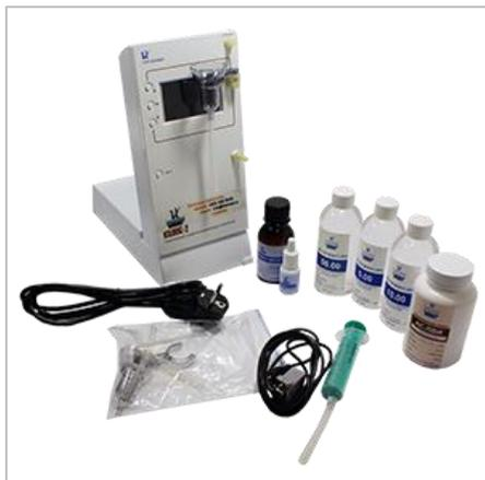
Анализатор спиртосодержащих напитков Уликор предназначен для измерения массовой доли этилового спирта и массовой доли экстракта в спиртосодержащих напитках алкогольной, слабоалкогольной продукции и водноспиртовых растворах, а также экстрактивности начального сусла в пиве в соответствии с методикой выполнения измерений, аттестованной в установленном порядке.
