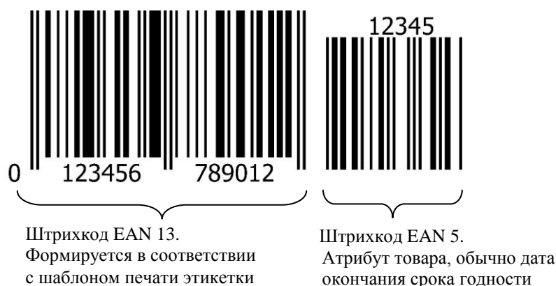
Рис. 6.2 – Структура штрихкода EAN 13+5
