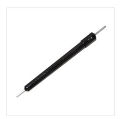
Ртутно-пленочный электрод (РПЭ) представляет собой полимерный стержень с запрессованным серебряным стержнем меньшего диаметра. Для приведения в рабочее состояние в день проведения измерений на поверхности серебряного стержня формируют амальгаму серебра путем нанесения тонкого слоя ртути. Нанесение ртути проводят электролизом раствора нитрата одновалентной ртути в электрохимической ячейке анализатора.
