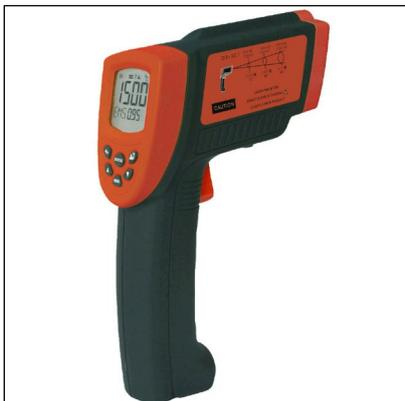
Профессиональный пирометр **CONDROL IR-T4** предназначен для быстрого бесконтактного измерения температуры поверхности твердых (сыпучих, текучих) тел и жидкостей (расплавов) всевозможных промышленно-бытовых объектов и материалов, фиксируя их тепловое излучение.
