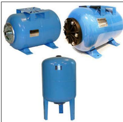
Гидроаккумулятор предназначен для постоянной поддержки определенного уровня давления в системах водоснабжения, а также предохранения насоса от частого включения, выдачи своего запаса воды при отключении напряжения в сети и снижения вероятности появления гидроударов.
