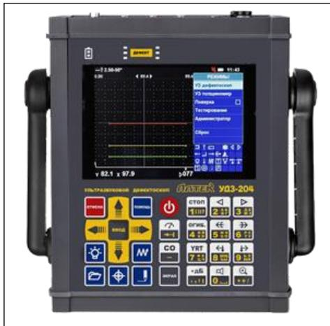
УДЗ-204 - дефектоскоп общего назначения. Прибор предназначается для проведения ультразвукового контроля, а также используется в качестве толщиномера.
