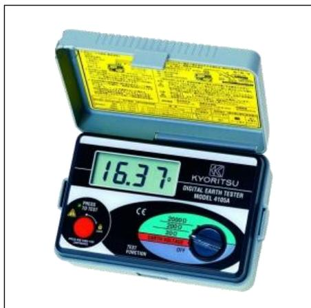
Цифровой портативный прибор KEW 4105A представляет собой измеритель сопротивления заземления, применяемый в самых различных областях. Прибор оснащен функцией измерения напряжения заземления. Комплект поставки включает в себя комплект измерительных проводов с наконечниками и зажимами типа "крокодил".
