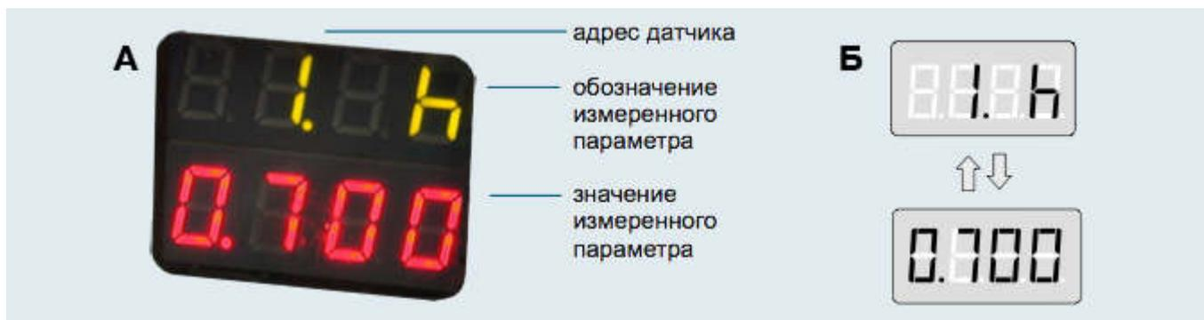
Рис. 2. А - структура дисплея с двумя строками; Б - отображение информации дисплеем, имеющим одну строку.
