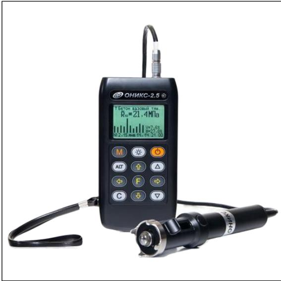
Универсальный измеритель прочности строительных материалов ОНИКС-2.5 предназначен для оперативного контроля прочности, однородности и класса тяжелого, лёгкого и высокомарочного бетона методом ударного импульса (ГОСТ 22690) при технологических испытаниях и обследовании объектов, а также для контроля кирпича, раствора и др. строительных материалов.
