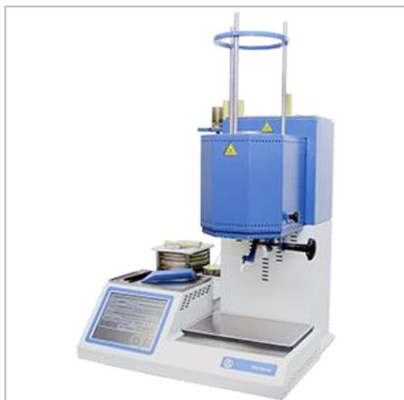
Установка ПТР-ЛАБ-02 предназначена для определения показателя текучести расплава термопластов в полном соответствии с требованиями ГОСТ 11645-73, ASTM D1238 (Procedure A), ISO 1133 (method A), а также другим аналогичными методам в диапазонах температур +50...+450°C.
