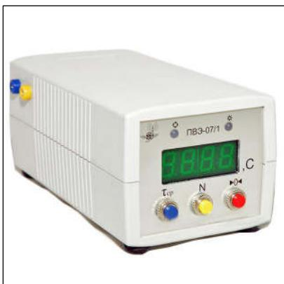
Электронный секундомер «ПВЭ-07 /1» предназначен для измерения интервалов времени срабатывания и отпуска реле и других контактных устройств, формирования среднего значения по результатам нескольких измерений, подсчета числа измерений и индикации результатов в цифровой форме.
