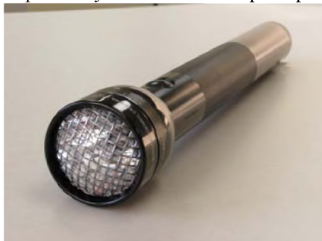
Рисунок 1 – Источник излучения тестовый ИТЭС
