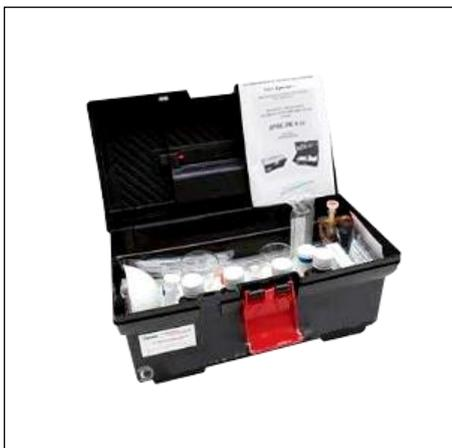
Комплектная лаборатория Пчёлка-Н предназначена для определения уровня содержания нефтепродуктов в растворенной и эмульгированной формах в природных водах любой степени минерализации, включая морские, а также в сточных водах.
