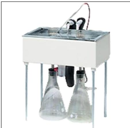
Баня для парафина используется в аппарате фильтрации при проведении анализа в соответствии с ГОСТ 11851-85 "Нефть. Метод определения парафина".
