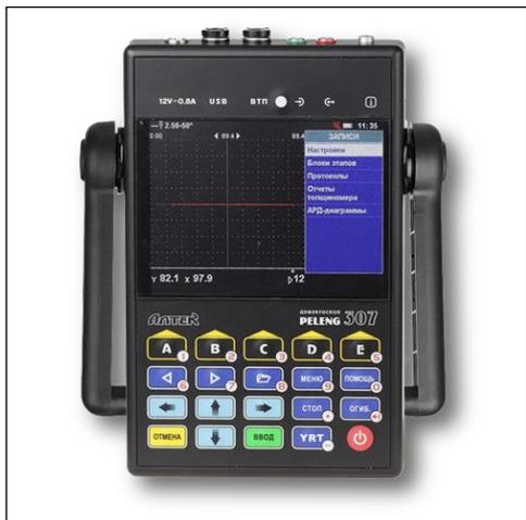
УДЗ-307ВД (PELENG-307) - прибор неразрушающего контроля. Прибор предназначается для проведения ультразвукового контроля, а также используется в качестве толщиномера.
