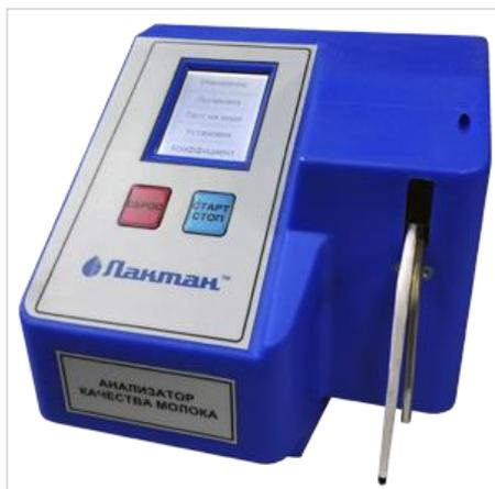
Анализатор Лактан 1-4М исп.600 УЛЬТРАМАКС позволяет ультразвуковым методом без использования химических реактивов измерить 11 параметров молока: содержание массовой доли жира, белка, СОМО, лактозы, плотности, добавленной воды, точки замерзания, общего белка, минеральных солей и калорийности в пробе молока, а также температуру пробы.
