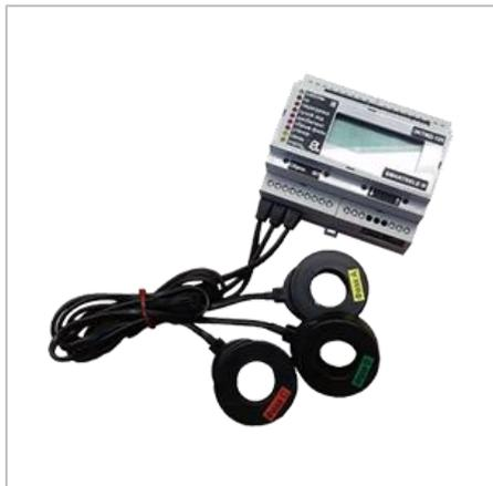
Контроллер ЭКТМ-Д предназначен для установки в цепях питания трехфазных электродвигателей и других электроустановок переменного тока промышленной частоты 50 Гц напряжением 220/380 В для повышения их надежности и увеличения срока службы. При косвенном подключении через трансформаторы тока контроллеры могут использоваться в электролиниях на любое напряжение.
