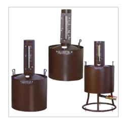
Технические мерники 1-го класса М1кл предназначены для измерения объемного количества жидкостей методом слива и налива.
