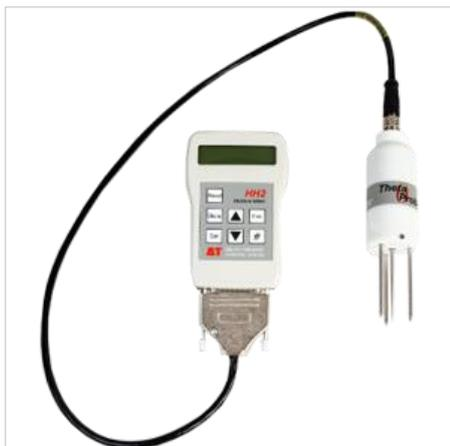
Влагомеры серии НН2 предназначены для измерения влажности почвы и грунта.
