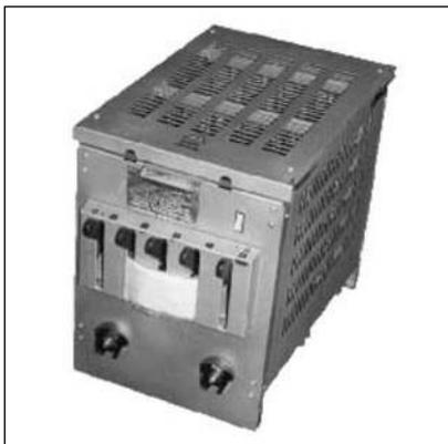
Балластный реостат «РБ-306» предназначен для регулирования тока в многопостовых сварочных выпрямителях, а также для обеспечения требуемой крутизны внешней вольт-амперной характеристики в любых сварочных источниках.
