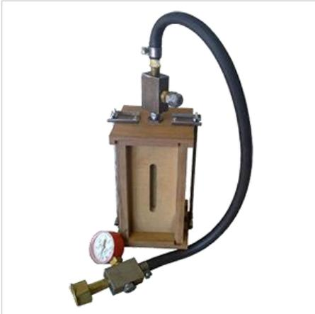
Установка предназначена для получения сухого льда, применяют к аппаратам: ПАФ, ЛЗН-75М и МП-1.
